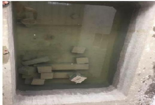
**FIG 3.1.- CURING TANK**
