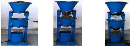
**FIG. 2 . 9 . - COMPACTION FACTOR PROCEDURE**
