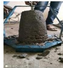
**FIG 2.8.SLUMP TEST**
