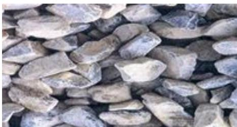
**FIG- 2.1. COARSE AGGREGATE**
